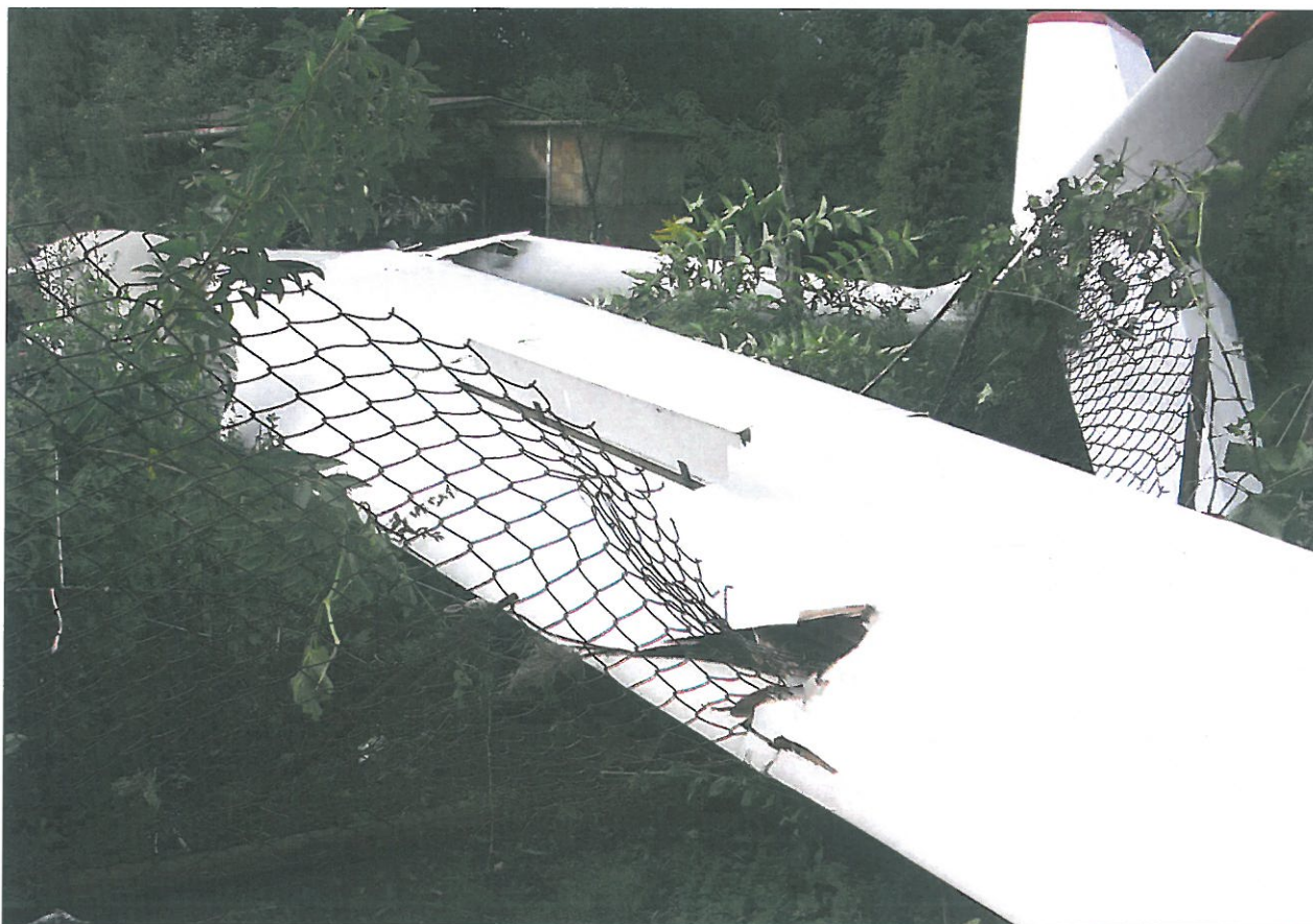
8 – Szybowiec na miejscu wypadku, zbliżenie na uszkodzenie noska lewego skrzydła.
