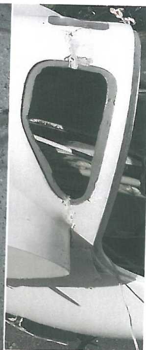
39 – wyraźnie zaznaczona granica zniszczenia kadłuba.
