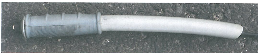
17, 18 – Wyłamany do tyłu drążek tylny i zbliżenie przełomu – widać doraźny charakter przełomu.
