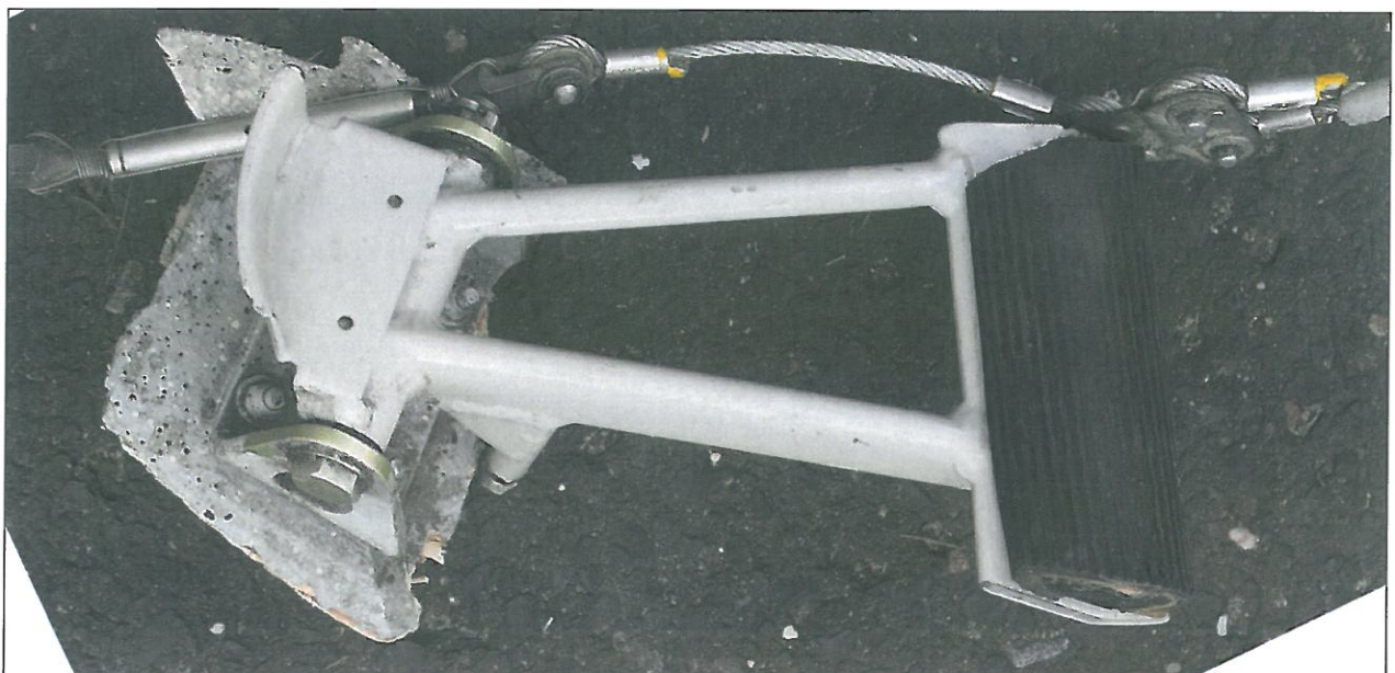
32 – Pedał lewy tylnej sterownicy nożnej, oderwany od skorupy kadłuba. Linki sterowania odcięte.
