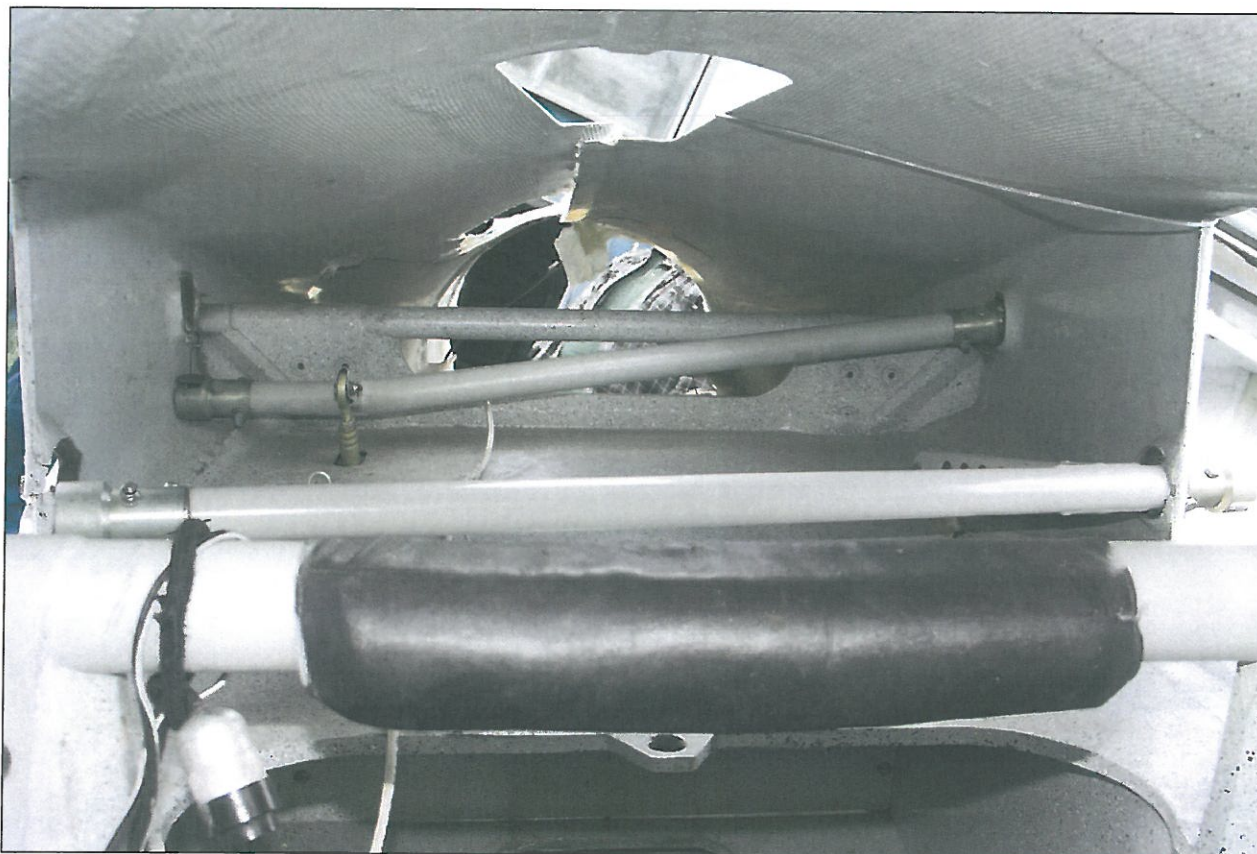
46 – Widok na wnętrze kadłuba za kabiną. Na pierwszym planie podglówek fotela tylnego, za nim wyrwana z prawej obsady przednia rura skrętna sterowania hamulcami aerodynamicznymi, w głębi widoczna zgięta tylna rura skrętna sterowania lotkami.
