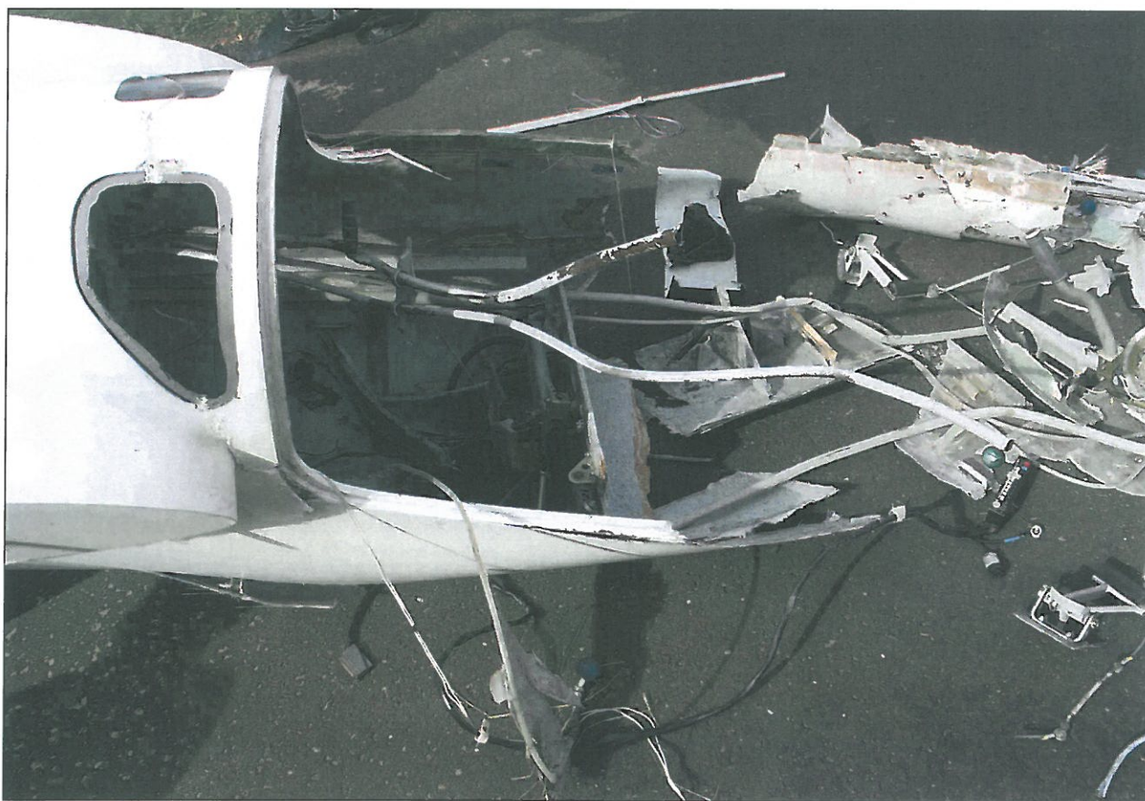
34 – Zniszczona przednia część kadłuba, rejon tylnego fotela – widok ogólny.
