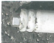
29, 30, 31 – Jeden z popychaczy sterowania w kabinowej części kadłuba, dobrze widoczny charakter jego zniszczenia; obok zbliżenia jego zniszczonych końcówek.
