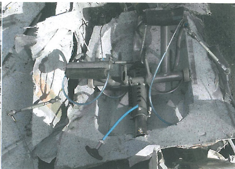
16 – Zespół przednicy sterownic nożnych, wyłamany wraz z dużym fragmentem przedniej podłogi.
