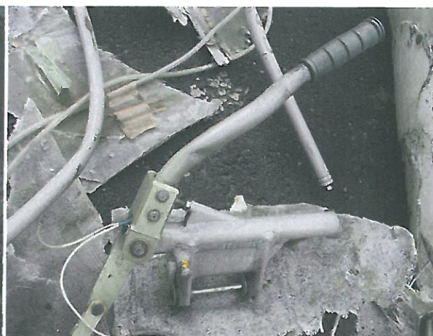
22, 23 – Zespół sterownicy ręcznej przedniej widziany z tyłu (po lewej) i z przodu (po prawej). Widoczna obsada drążka z wygiętym na bok w lewo drążkiem sterowym, zamocowana do oderwanego fragmentu konstrukcji i popychacz łączący ją z układem sterowania lotkami.
