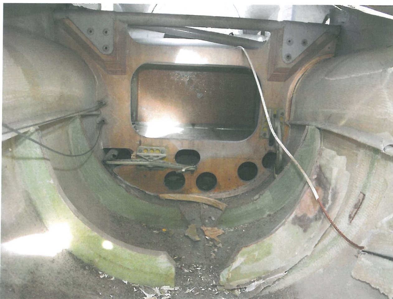
41 – Wnętrze środkowej części kadłuba pod skrzydłami, widziane od tyłu. Widoczne zniszczenia struktury oraz linki i zamocowane na wrędze dźwignie układu sterowania płotowcem z odłamanymi końcówkami popychaczy.
