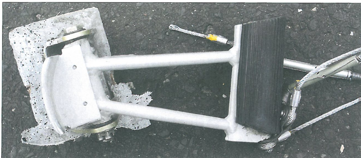
33 – Pedał prawy tylnej sterownicy nożnej, oderwany od skorupy kadłuba. Linki sterowania odcięte.
