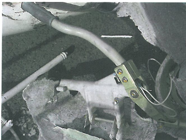
22, 23 – Zespół sterownicy ręcznej przedniej widziany z tyłu (po lewej) i z przodu (po prawej). Widoczna obsada drążka z wygiętym na bok w lewo drążkiem sterowym, zamocowana do oderwanego fragmentu konstrukcji i popychacz łączący ją z układem sterowania lotkami.
