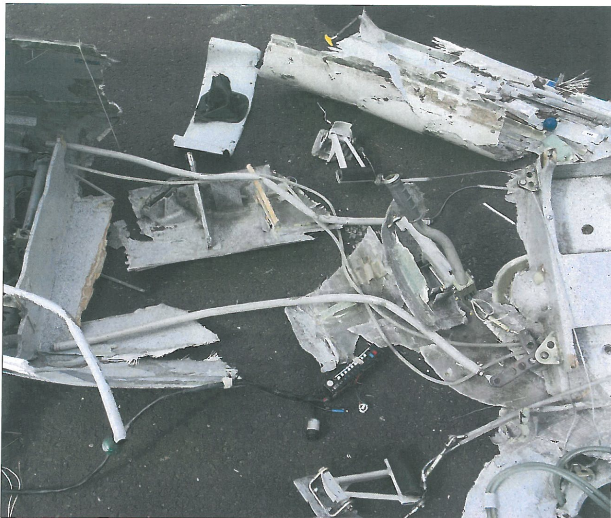
35 – Zniszczona przednia część kadłuba, rejon przedniego fotela – widok ogólny.
