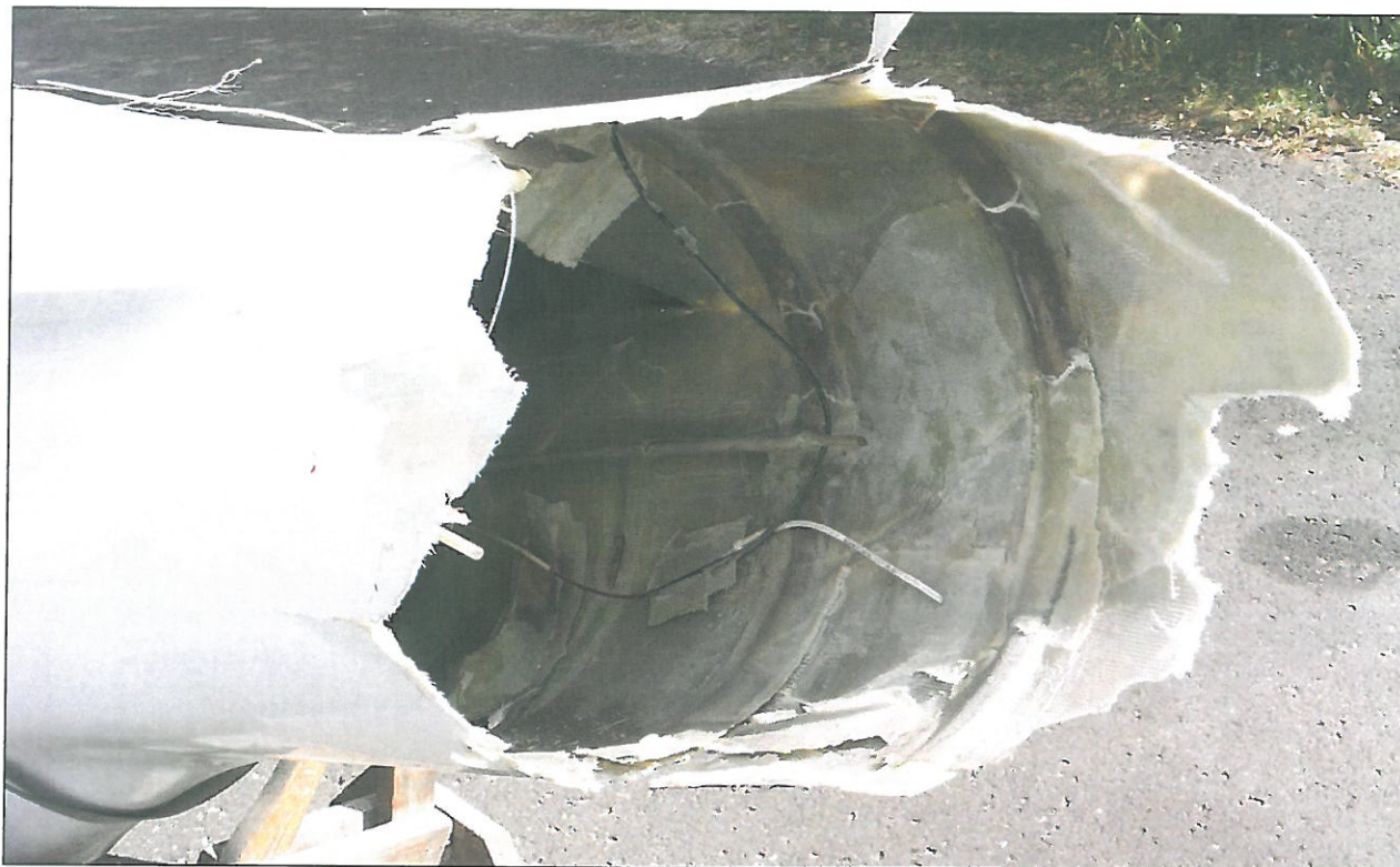
40 - Przełom kadłuba w miejscu odłamania belki ogonowej.
