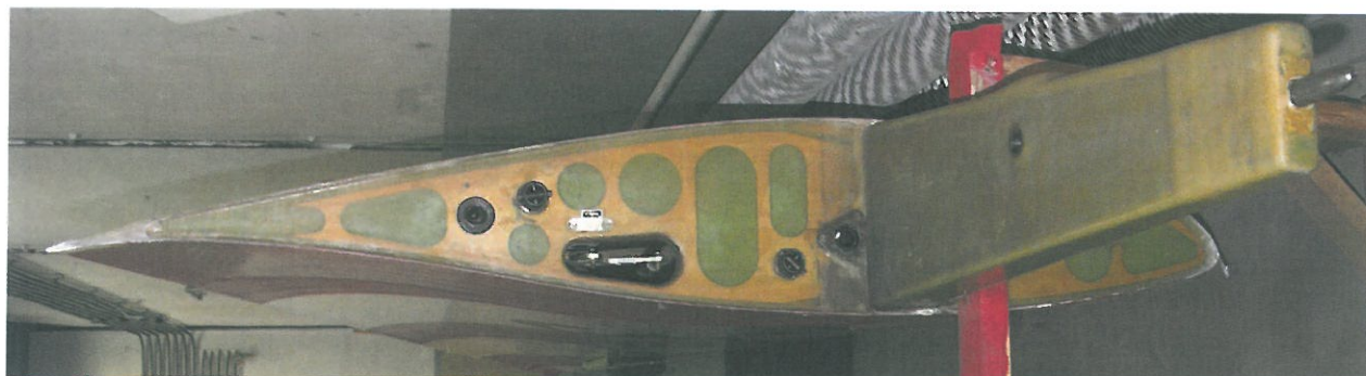
47 – Żebro nasadowe lewego skrzydła. Widoczne szybkorozłączne złącza sterowania hamulcami aerodynamicznymi (bliżej dźwigara) i lotkami.
