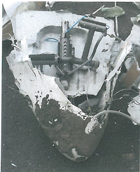
15 – Nosek kadłuba ze śladami ziemi i przednią podłogą z zespołem sterownic nożnych.
