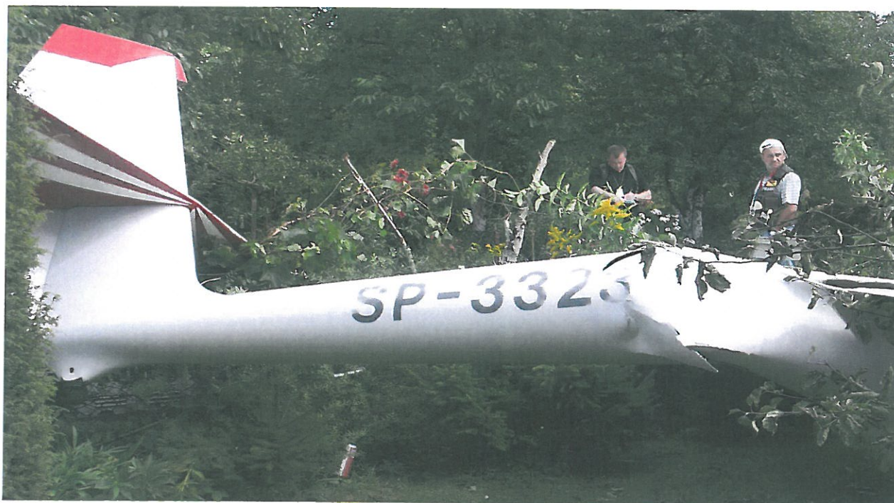
13 – Tylna część kadłuba z usterzeniem, odłamana od reszty kadłuba za skrzydłami.
