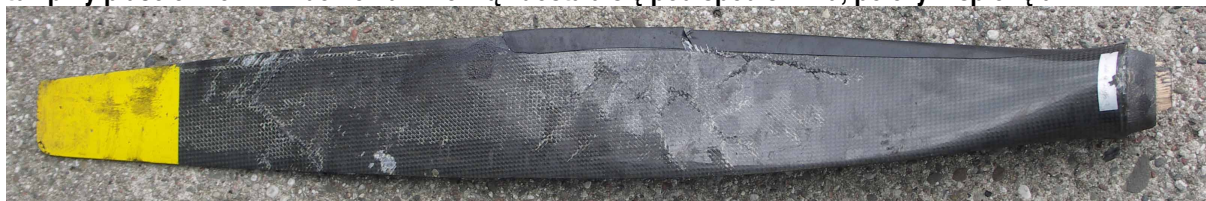
35 i 36 – Łopaty śmigła – u góry pozostająca w piaście, u dołu – oderwana. Trzecia łopata uległa złamaniu tuż przy piaście w chwili zderzenia z ziemią i dostała się pod spód silnika, po czym spłonęła.
