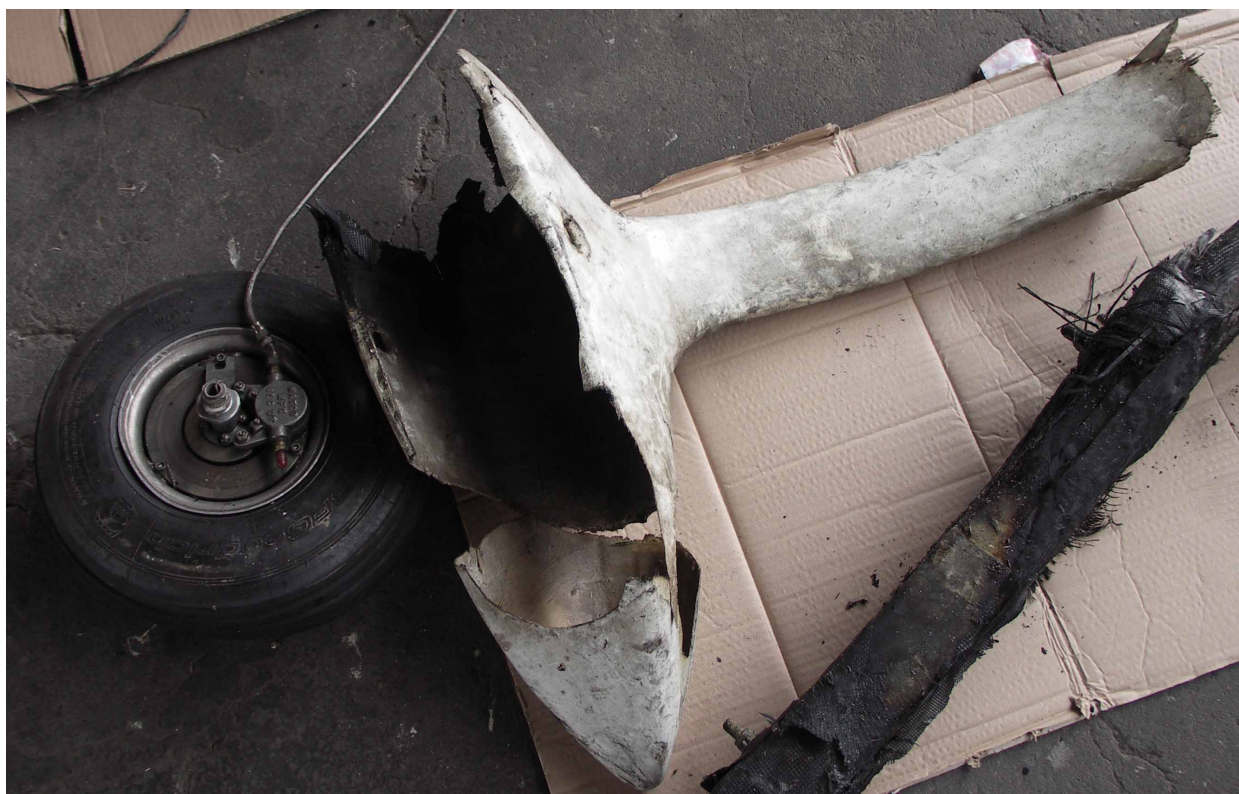
31 – Szczątki prawego podwozia głównego. Obok widoczny fragment spalonej goleni podwozia.
