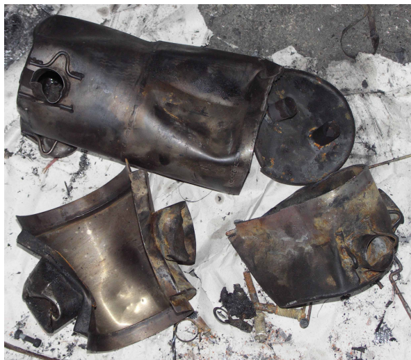
63 i 64 – Kolektor spalin po rozcięciu i rozebraniu na elementy.
