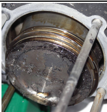
40, 41, 42 – Stan tłoków w trzech mniej uszkodzonych cylindrach.
