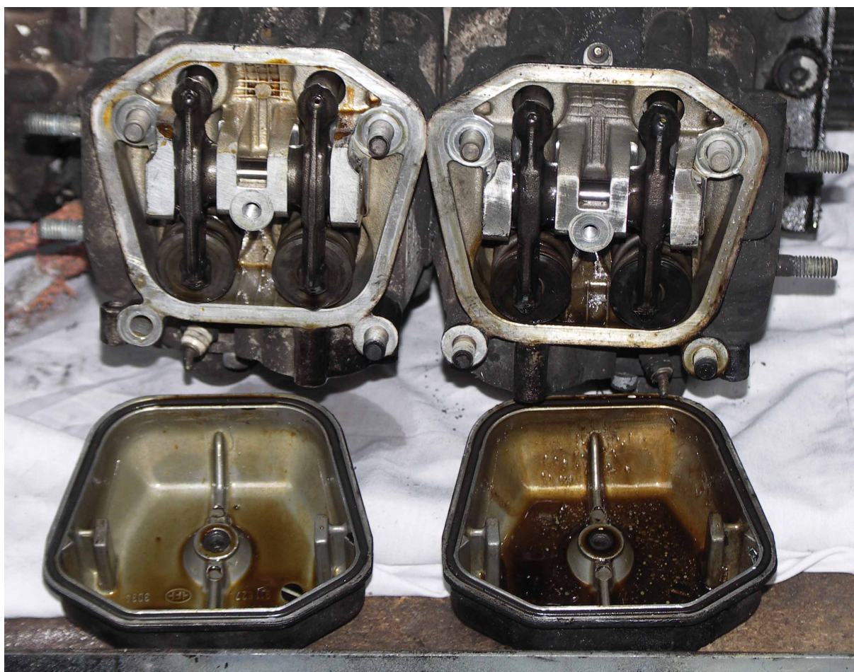
50 – Głowice mniej uszkodzonych cylindrów po zdjęciu osłon.
