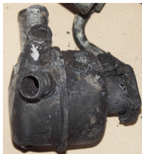
52 – Zbiorniczek ekspansyjny płynu chłodzącego
