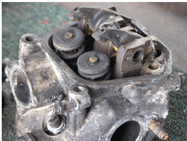
48 i 49 – Głowice bardziej uszkodzonych cylindrów bez osłon.
