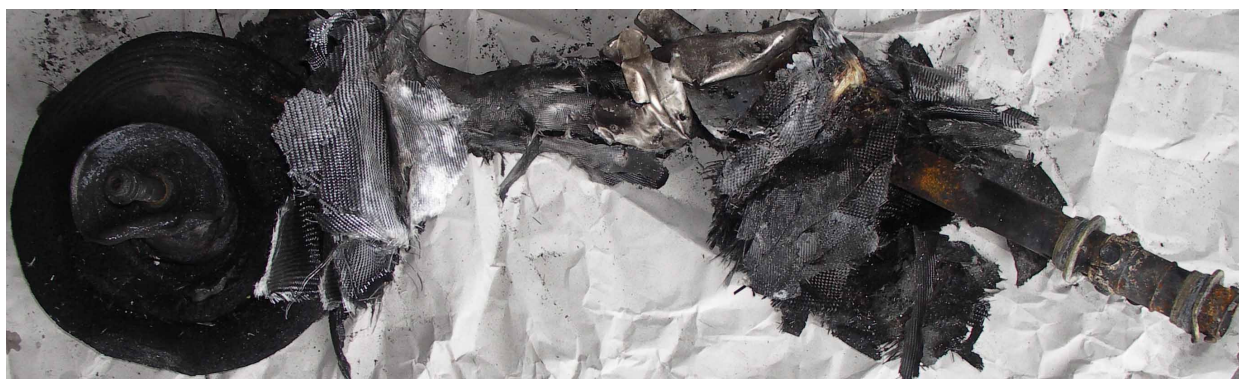
30 – Szczątki przedniego podwozia.
