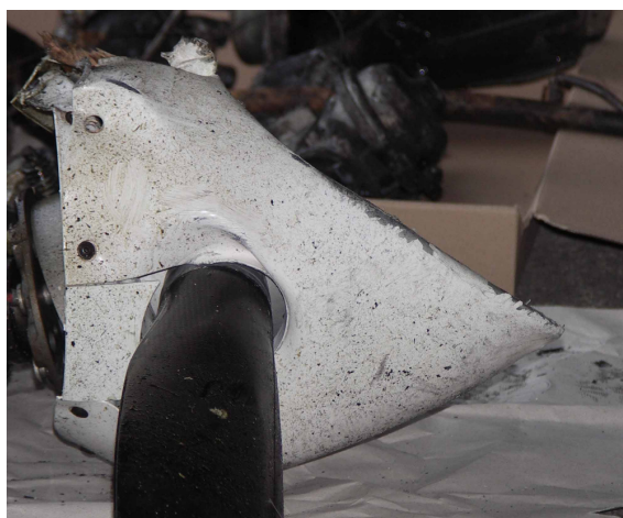
33 i 34 – Kołpak śmigła z piastą i jedną nie oderwaną łopata. Na zdjęciu 29 wyraźnie widać spłaszczenie kołpaka, odtwarzające położenie płaszczyzny podłoża względem osi silnika w chwili zderzenia z ziemią.
