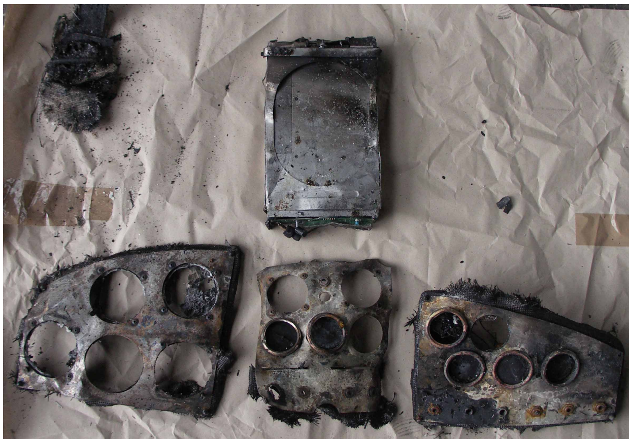
13 – Zniszczone pożarem tablice przyrządów i radiostacja.
