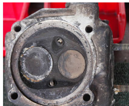
37, 38, 39 – Wnętrza zdemontowanych głowic cylindrów, widoczny stan zaworów.
