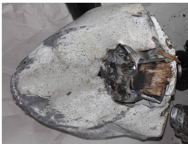
33 i 34 – Kołpak śmigła z piastą i jedną nie oderwaną łopata. Na zdjęciu 29 wyraźnie widać spłaszczenie kołpaka, odtwarzające położenie płaszczyzny podłoża względem osi silnika w chwili zderzenia z ziemią.
