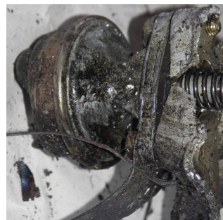
53 – Pompa paliwowa silnika.
