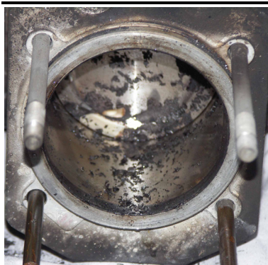
40, 41, 42 – Stan tłoków w trzech mniej uszkodzonych cylindrach.
