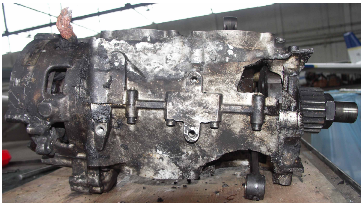
45 – Korpus silnika od spodu – po prawej widoczne miejsca odłamania jednego z cylindrów i reduktora.
