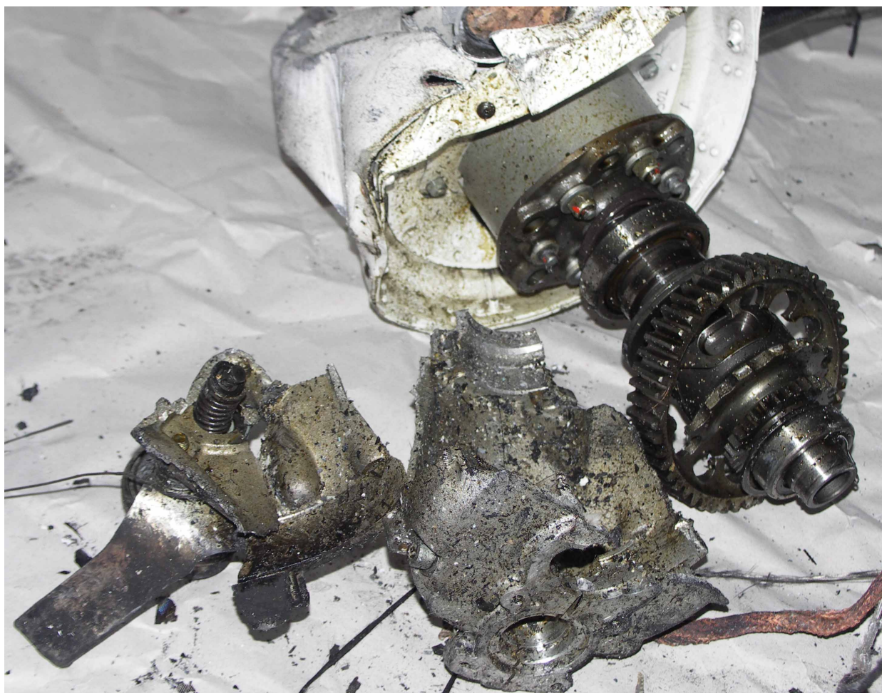
24 i 25 – Zniszczony reduktor silnika i piasta śmigła.
