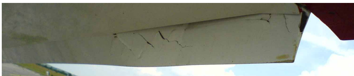
7 – Uszkodzenia lewej lotki. Widoczne ślady roślinności na dolnej powierzchni skrzydła.
