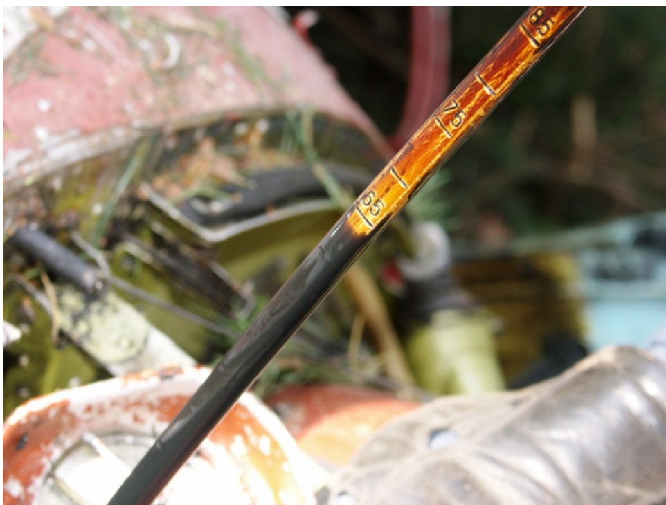
Fot. 20. Miarka ilości oleju; ślad na miarce wskazuje, że w silniku była dostateczna ilość oleju.
