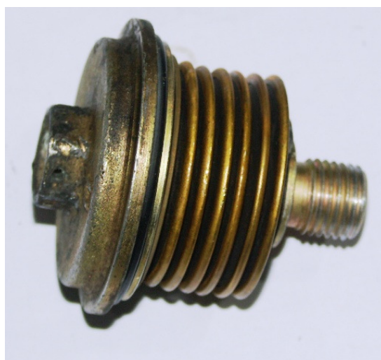
Fot. 42. Filtr gaźnika (dokładnego oczyszczania) – czysty
