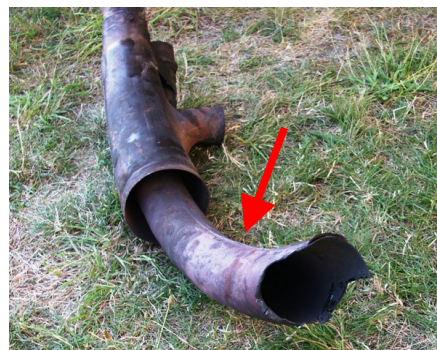
Fot. 36. Rura żarowa Sz6800-153-2 (wskazana strzałką) – uszkodzony w eksploatacji kielich połączenia z rurą zimnego powietrza.
