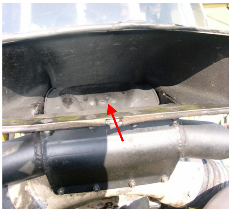
Fot. 32. Widok z przodu na wlot powietrza do gaźnika samolotu niezwiązanego z wypadkiem – strzałka wskazuje na klapkę sterującą podgrzewem powietrza do gaźnika.
