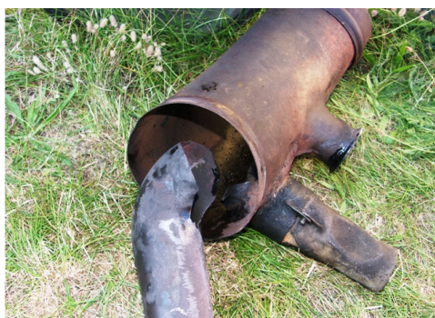
Fot. 35. Segment Sz6800-148 – ułamana w momencie zderzenia z ziemią rura zimnego powietrza.
