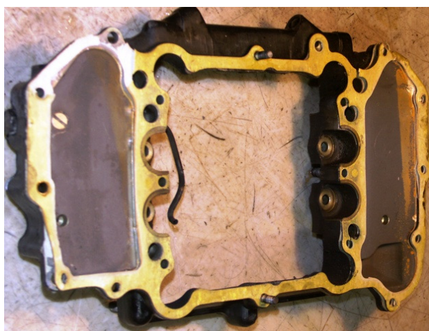
Fot. 39. Pokrywka gaźnika z widocznymi śladami wody w prawej i lewej komorze pływakowej
