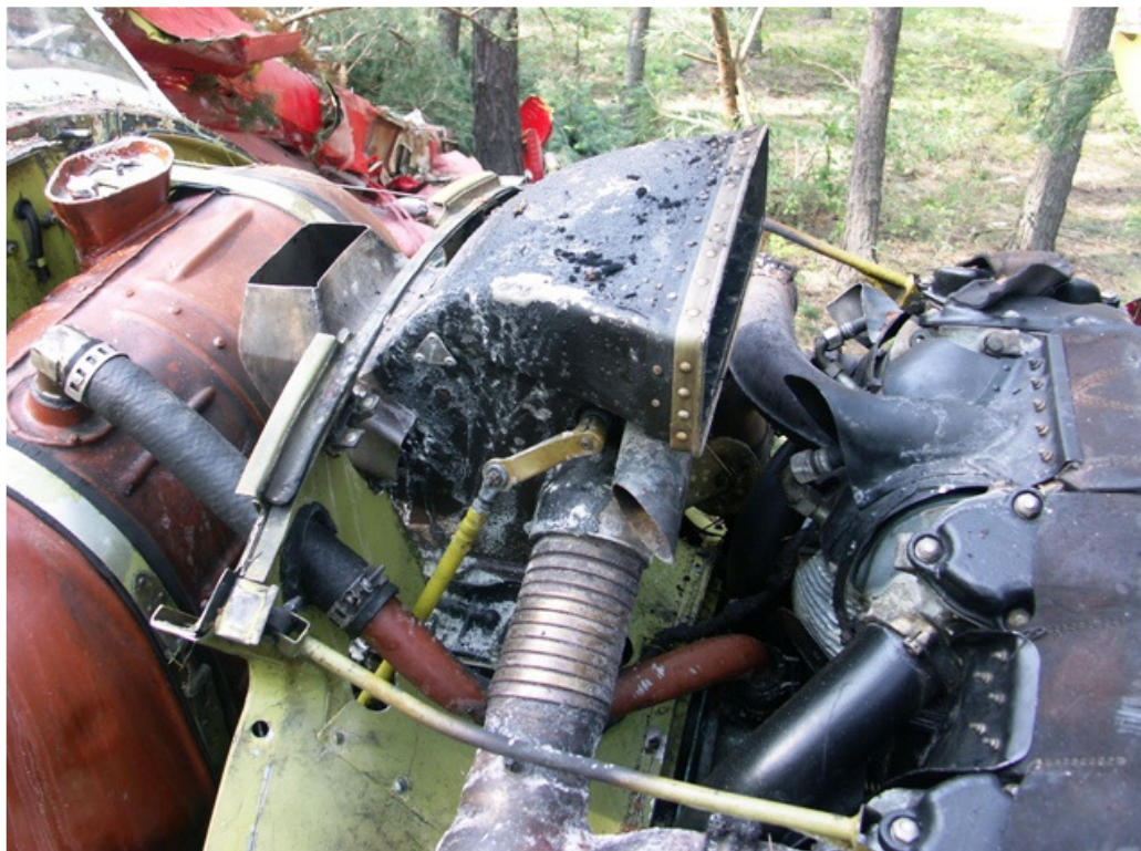
Fot. 17. Wlot powietrza do gaźnika po ugaszeniu pożaru.
