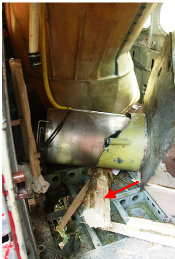
Fot. 30. Strzałka wskazuje pień drzewa (przecięty w czasie akcji ratowniczej), który zablokował drzwi kabiny, zmuszając załogę do ewakuacji dziurą po prawej stronie kadłuba (poprzednie zdjęcie)
