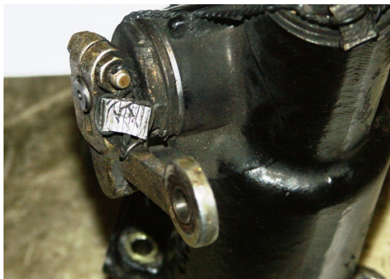
Fot. 43. Ślimak regulacji poprawki wysokości z plombą HYDRAŁ-WROCŁAW.
