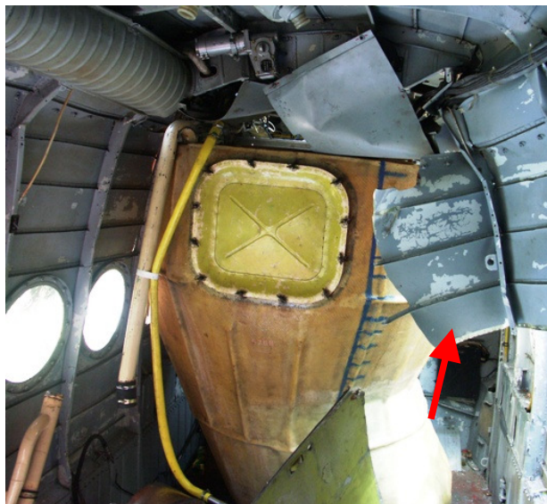
Fot. 29. Kabina pasażerska z zabudowanym zbiornikiem na wodę; strzałka wskazuje rozdarte poszycie po prawej stronie kabiny którą ewakuowała się załoga.
