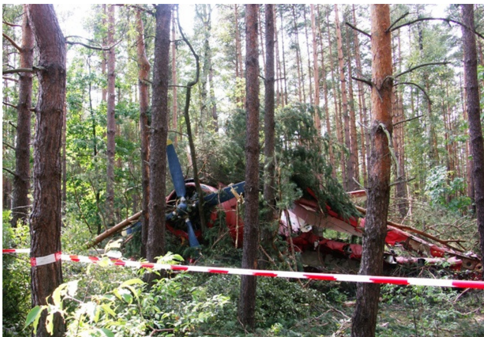
Fot. 9. Wrak samolotu w lesie po awaryjnym lądowaniu; zdjęcia od nr 9 do nr 16 wykonywane były z czterech kierunków (przemieszczanie aparatu – zgodnie z ruchem wskazówek zegara).
