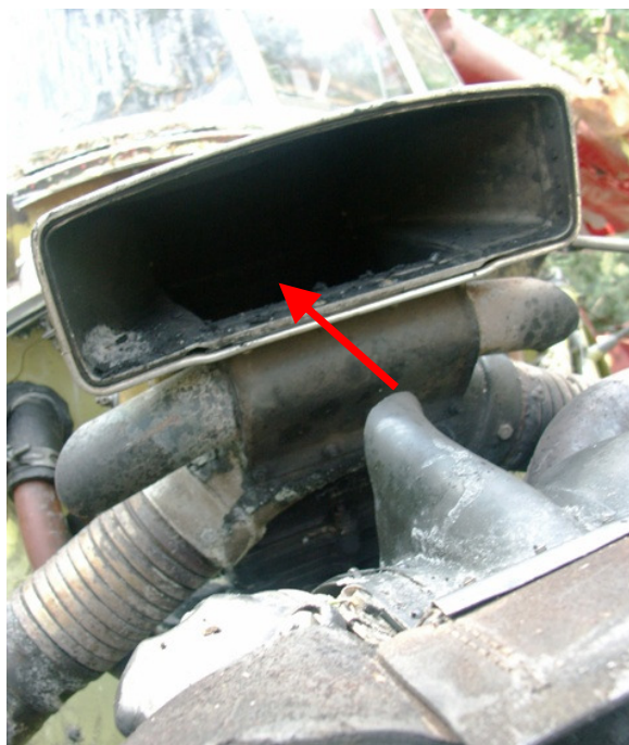
Fot. 31. Widok z przodu na wlot powietrza do gaźnika – strzałka wskazuje na brak klapki sterującej podgrzewem powietrza do gaźnika.
