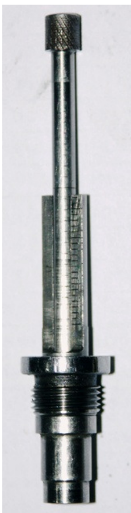
Fot. 44 i 45. Przrząd do sprawdzania ustawienia poprawki wysokości (po lewej) oraz przrząd wkręcony w badany gaźnik (po prawej) powinien wskazywać 3,4 mm (dla warunków: 762 mm Hg, 21 0 C) a wskazuje 2,3 mm.
