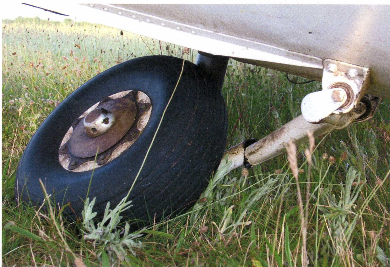
4 – Uszkodzone podwozie z prawej strony, widoczny złamany wahacz.
