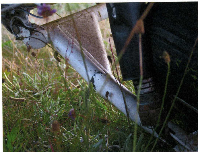
8 i 9 – Widok złamanego wahacza z lewej strony – wyraźnie widoczny skrętno-giętny charakter złamania wahacza, na co wskazuje sposób odkształcenia ucha amortyzatora w jego mocowaniu na wahaczu.
