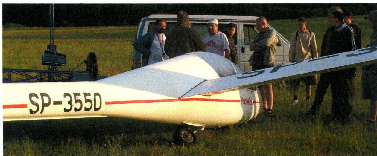
3 – Ogólny widok uszkodzonego szybowca, widoczne wytłamane podwozie.
