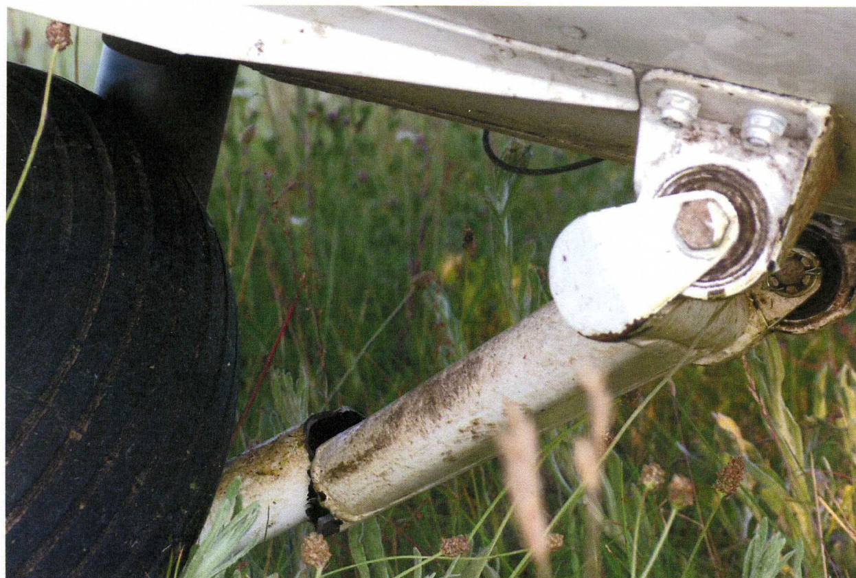
5 – Zbliżenie uszkodzonego podwozia z prawej strony, widoczny przełom wahacza i stan jego pokrycia lakierniczego.
