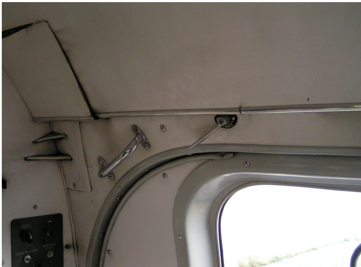
Fot.7 – Górne lewe narożne drzwi kabiny medycznej – widać uchwyt, a obok niego skrzydełko blokady drzwi.
