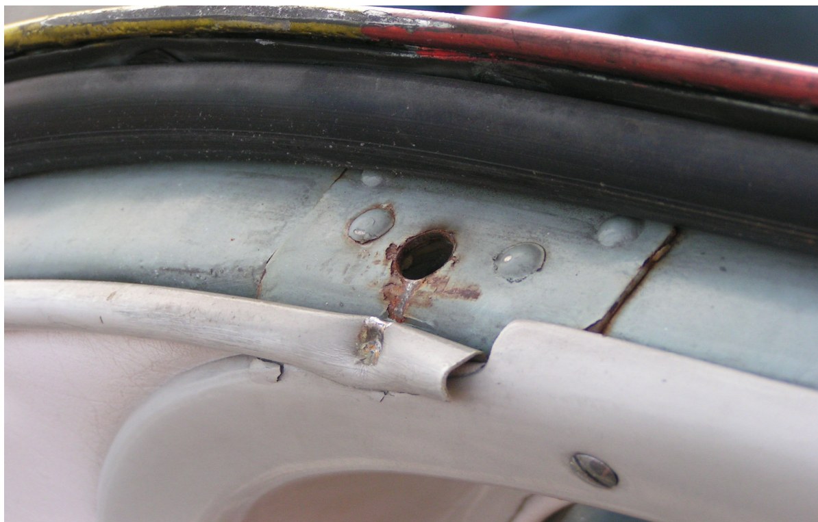
Fot.8 – Otwór w górnym obramowaniu drzwi pod sworzeń blokujący.
