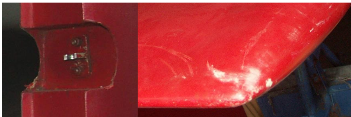
26 – Zniszczony górny zawias steru kierunku.
