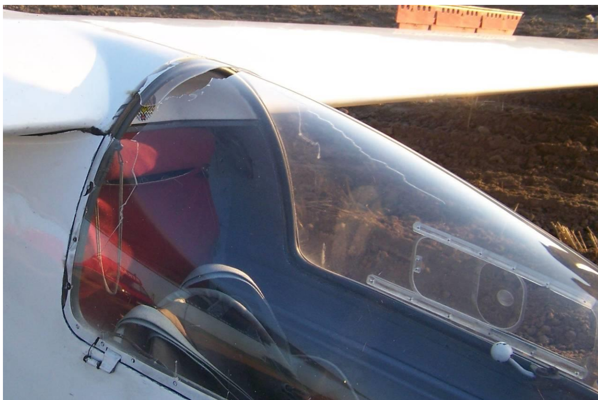
38 – Uszkodzone - pęknięte oszklenie osłony kabiny.
