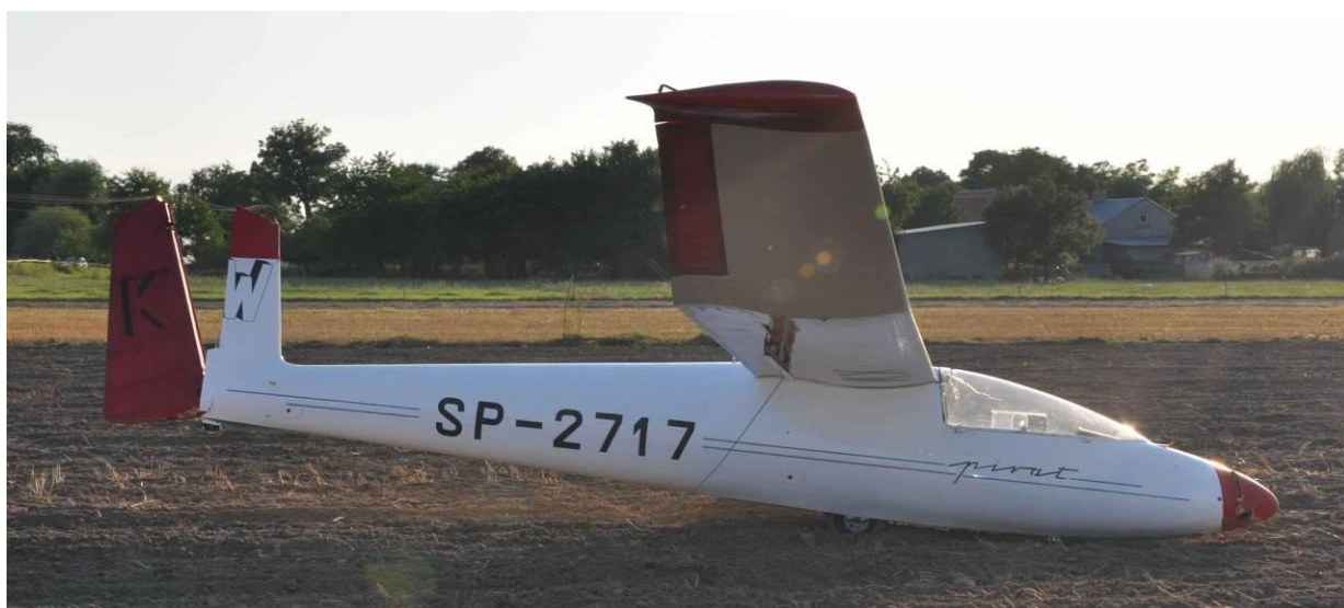
12 - Uszkodzony szybowiec, prawa strona. Pod skrzydłem dobrze widoczny zaczepiony zerwany przewód linii energetycznej.
