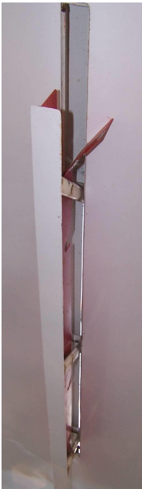
29, 30, 31 – Uszkodzony hamulec aerodynamiczny na prawym skrzydle (odgięta końcówka jednej z płyt), na fot.30 dobrze widoczny zaczepiony przewód linii energetycznej, który spowodował odgięcie końcówki płyty.
