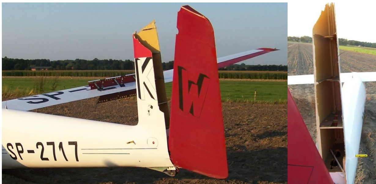
18, 19 – Tylna część kadłuba i uszkodzony statecznik pionowy ze sterem kierunku.
