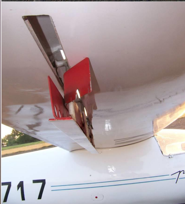
29, 30, 31 – Uszkodzony hamulec aerodynamiczny na prawym skrzydle (odgięta końcówka jednej z płyt), na fot.30 dobrze widoczny zaczepiony przewód linii energetycznej, który spowodował odgięcie końcówki płyty.
