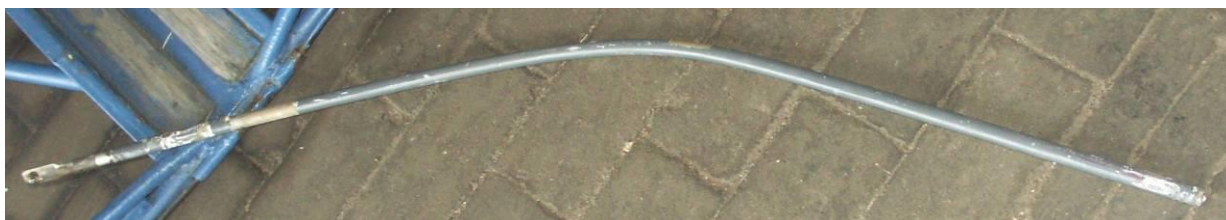
28 – Zniszczony popychacz steru wysokości.
