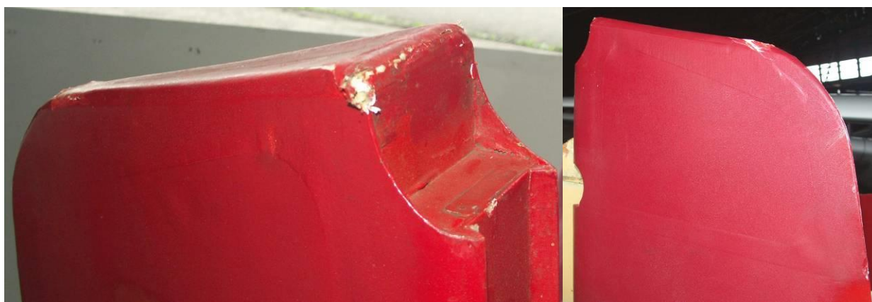
24, 25 – Górna końcówka steru kierunku – widoczne uszkodzenia.
