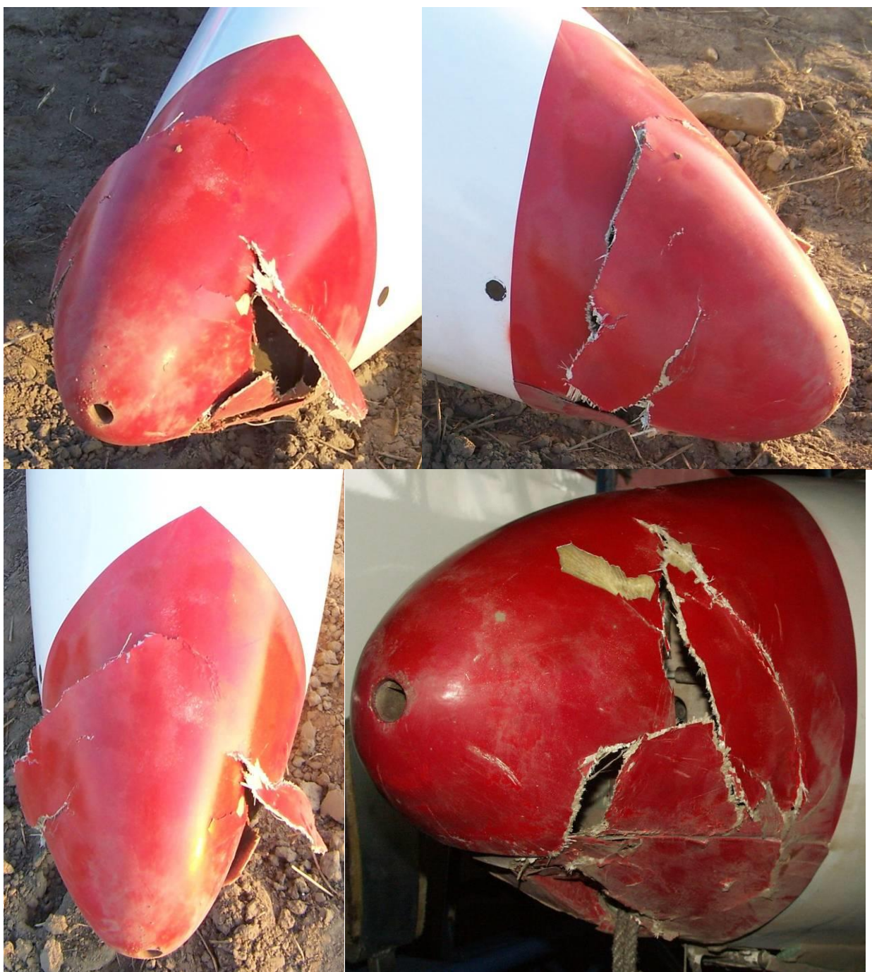
34, 35, 36, 37 – Zniszczony nosek kadłuba.
