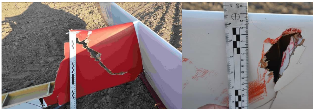
16, 17 – Uszkodzenie pokrycia statecznika pionowego przewodem linii energetycznej i przebicie statecznika poziomego.
