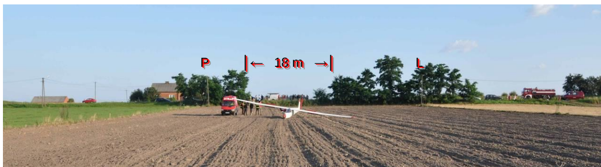
6 – Widok ogólny miejsca wypadku w kierunku przeciwnym do kierunku lądowania, z zaznaczonymi niektórymi elementami sytuacyjnymi (słupy L i P zerwanej linii energetycznej).
