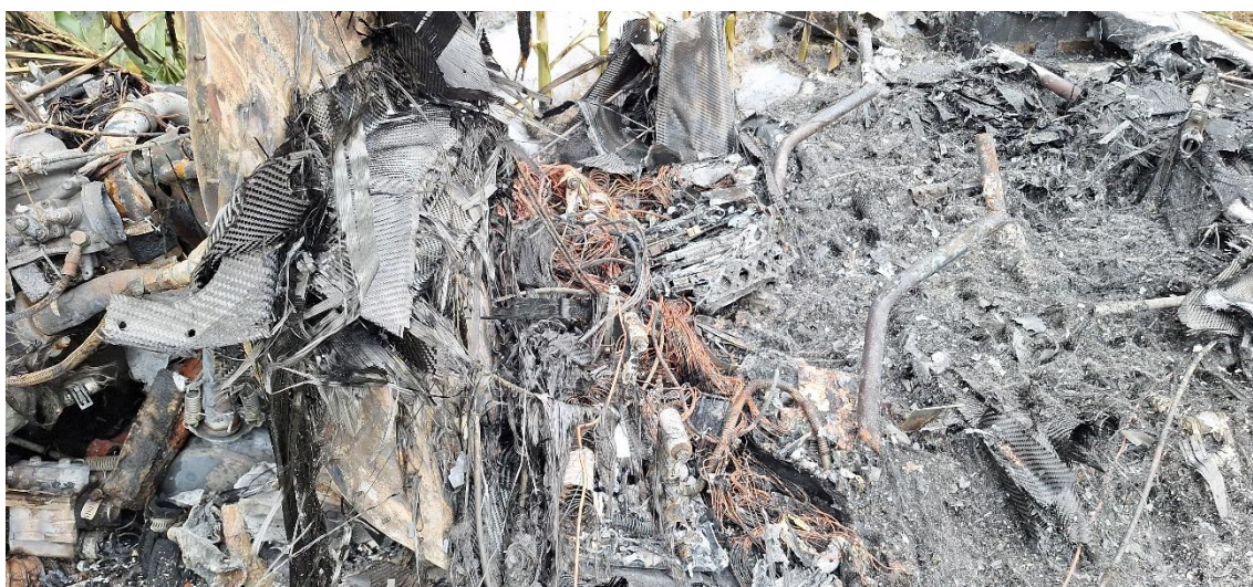
Rys. 7 Wypalona kabina oraz ściana ogniowa z fragmentem przedziału silnikowego samolotu. Widoczne pozostałości po okablowaniu przyrządów oraz dźwigi sterowe [źródło: PKBWL]
