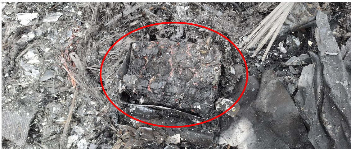
Rys. 8 Wypalony akumulator, znaleziony w zgliszczach [źródło: PKBWL]
